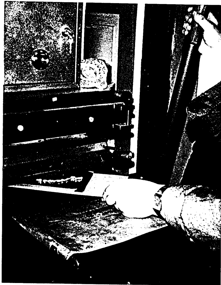
لوحة رقم (٨٢) : ابراز زخارف الصرة على الغلاف بالضغط بواسطة المكبس . (مكتبة السليمانية) .
