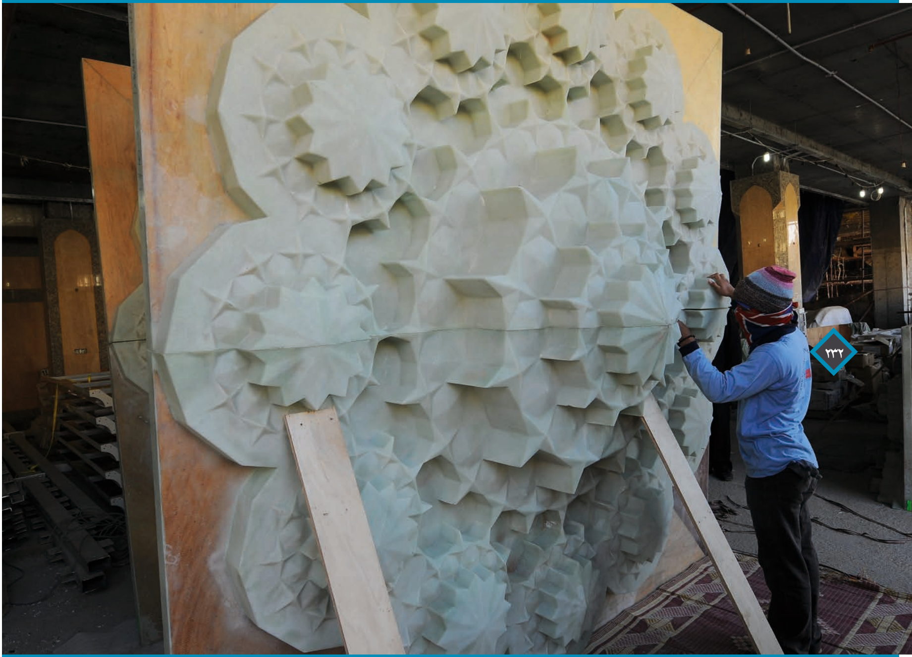
قوالب المقرنصات المصنوعة بإداة الفاير كلاس (٢٠١٣م)
